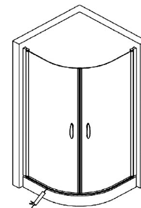
УВАГА! Після зборки потрібно дати час затвердіння герметику. Забороняється використання виробу протягом 24 годин після завершення монтажних робіт.
