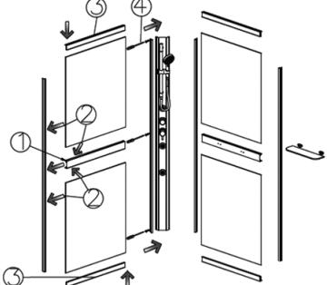
**ВНИМАНИЕ:** В профилях, устанавливаемых СЛЕВА и СПРАВО от стеклянных панелей, предустановлены резиновые прокладки обеспечивающие герметичность собранного изделия. Расположите данные прокладки в профиле в соответствии с размером стеклянных панелей.
